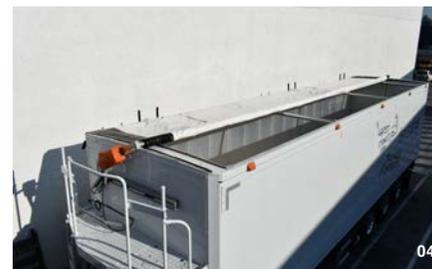
01 Bocchetta per il grano 02 finestra di ispezione laterale 03 bocchetta integrata 04 telo elettrico laterale
