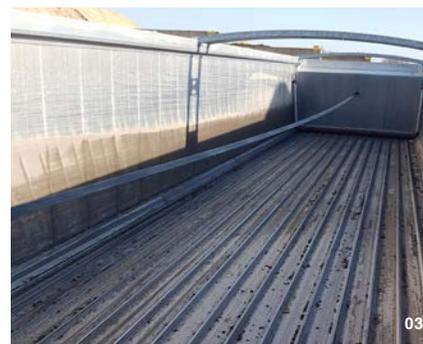
01 portellone pneumatico in due parti 02 HD SEALLESS floor 03 paratia idraulica
