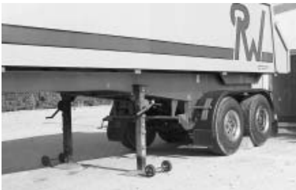
Supporti mobili del semirimorchio, qui utilizzati per sganciare un semirimorchio non equipaggiato con supporti propri a bordo.
