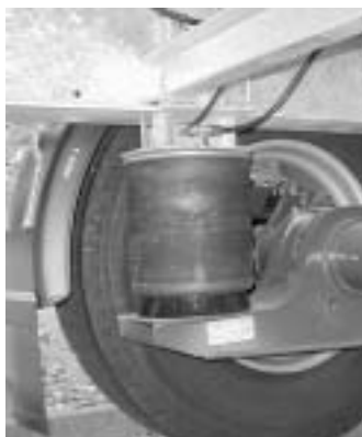
Sospensioni pneumatiche nel modello monobraccio
