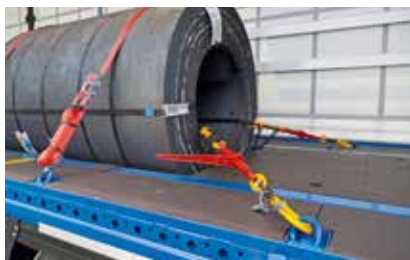
Posizione della buca coils (7,23 m, equipaggiamento di serie)
